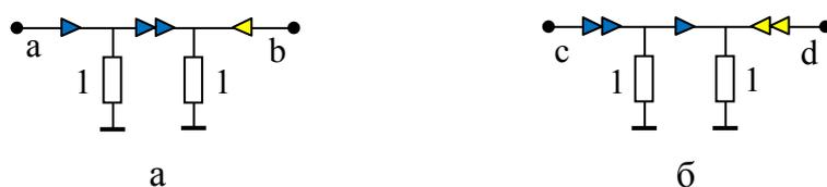
Рис. 3. Ориентированные нуллорные схемы замещения:
