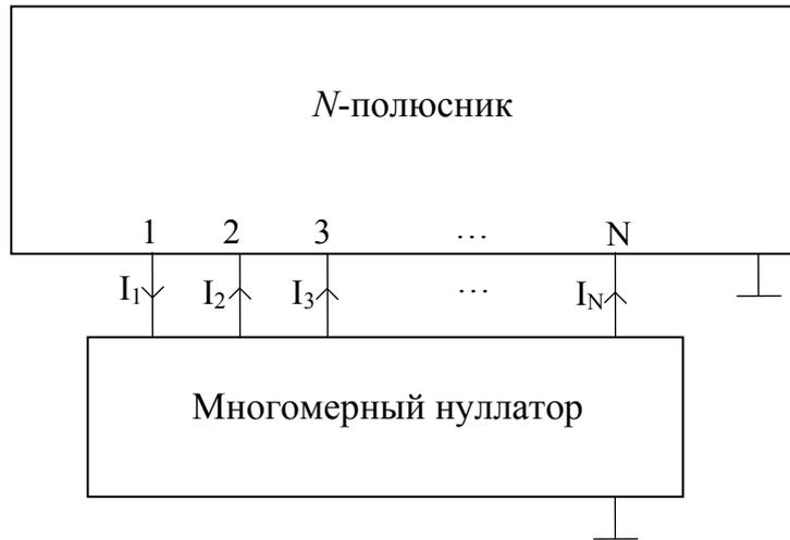
Рис.2. Подключение многомерного норатора
