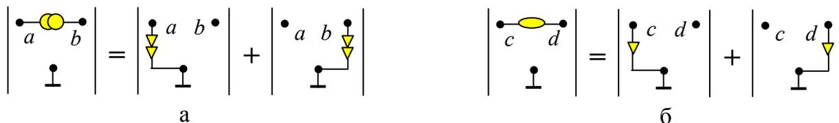
Рис. 3. Разложение зеркальных элементов на нулловые элементы, соответствующее алгебраическому тождеству (1)
