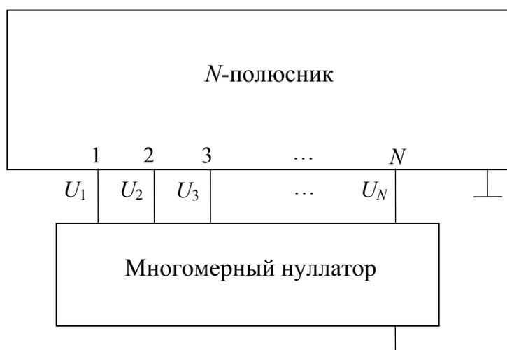
Рис. 1. Подключение многомерного нуллатора
