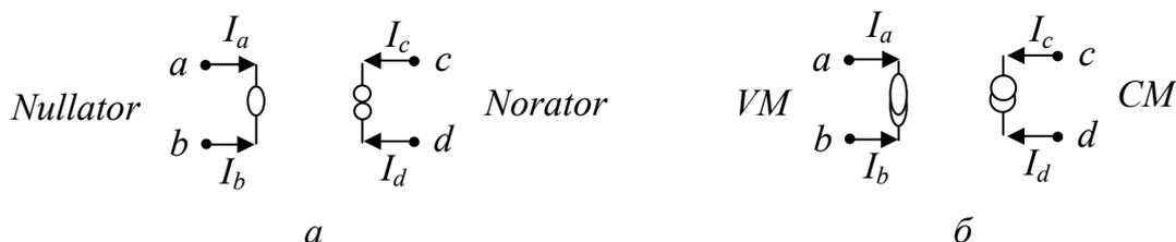
Рис. 1. Аномальные элементы: нулатор и норатор – а; зеркальный элемент напряжения (voltage mirror) и зеркальный элемент тока (current mirror) – б.
