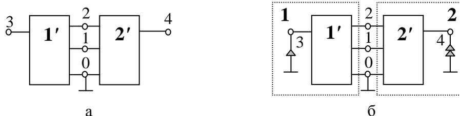
Рис. 2. Объединение двух четырехполюсных подсхем (а); несимметричный схемный минор объединенной подсхемы с ДВ 0110 (б)
