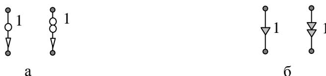
Рис. 3. Условные графические обозначения направленных нуллаторов и нораторов:
