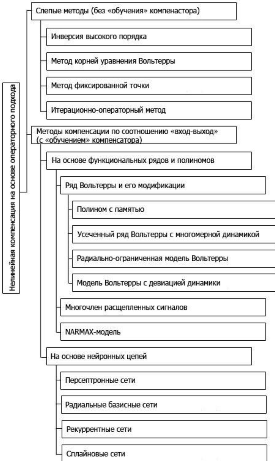
Рис.1. Классификация методов нелинейной компенсации
