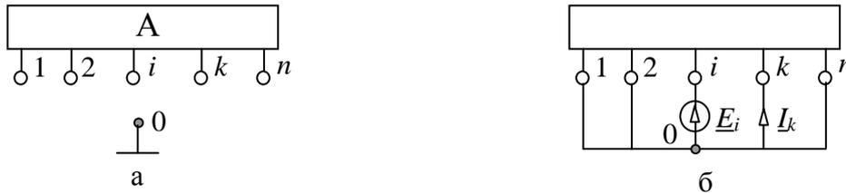
Рис. 1. Автономный – обозначен буквой А – многополюсник (а) и расчетная схема для параметра  $Y_{ki}$  на основе неавтономного многополюсника (б)
