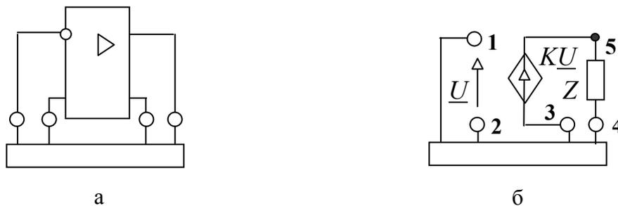
Рис. 3. Цепь с операционным усилителем (а) и ее схема замещения (б)
