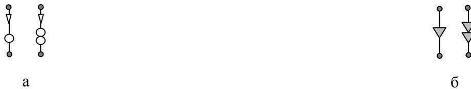
Рис. 1. Ориентированный нуллор (а) и неудаляемый управляемый источник (б)
